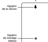
FIGURA 19: Parte posterior de la caja del programador
